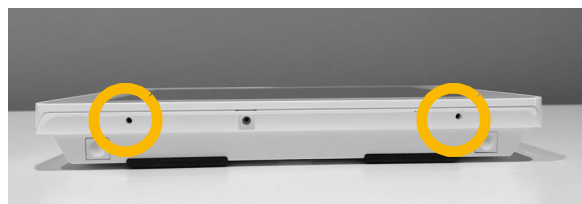
Les microphones sont situés sur la partie inférieure du panneau
